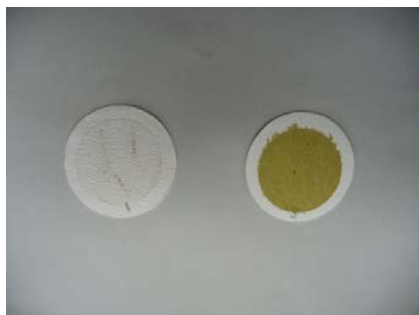
図9 SS測定後のガラス繊維ろ紙。左が青池、右が鶏頭場ノ池の検体をろ過した残渣
